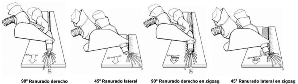
**Figura 5.-** Tres tipos de técnicas de ranurado: derecho, lateral y en zigzag.
