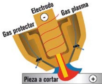
**Figura 2.-** Muestra una antorcha de plasma con consumibles para ranurado.
