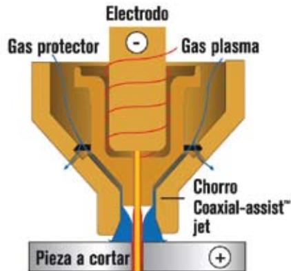
**Figura 1.-** Muestra el arco altamente constreñido con un agujero de 1.5 mm para un arco de corte de 100 Amperios.
